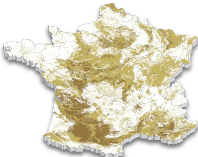
Le risque argile. La carte de France des sinistres dus à la sécheresse (à gauche) suit les territoires où le gonflement et la rétractation de l'argile provoquent des désordres dans les structures des bâtiments (à droite). Près de 80 départements sont et seront concernés.
